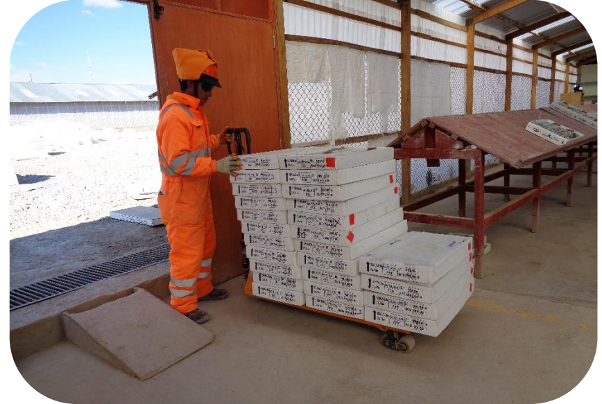
Manipulación de Cajas de Cores (Carga, Traslado y Descarga)
