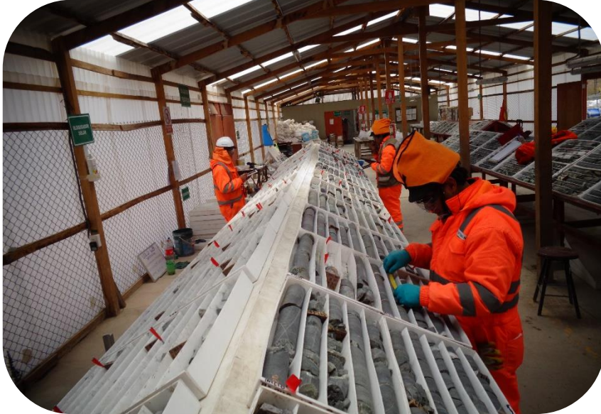
Logueo Geomecánico de Cores (GSI, RMR, Q)
