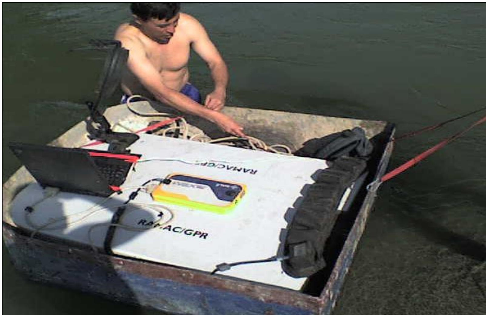
**VISTA DEL GEORADAR DE 100 MHz, SE COLOCO EN UNA BARCASA PARA EVITAR EL CONTACTO CON EL AGUA**
