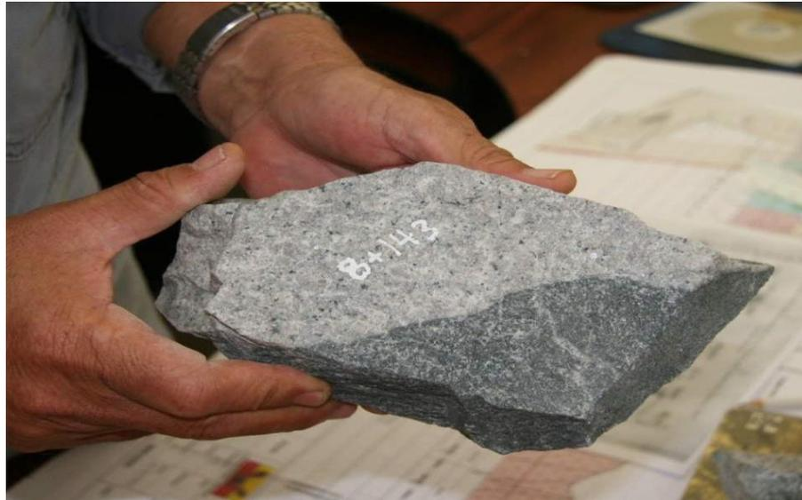
El potencial del estallido de rocas está relacionado con el UCS de la roca intacta y con la relación entre la resistencia a la compresión y la resistencia a la tracción.
