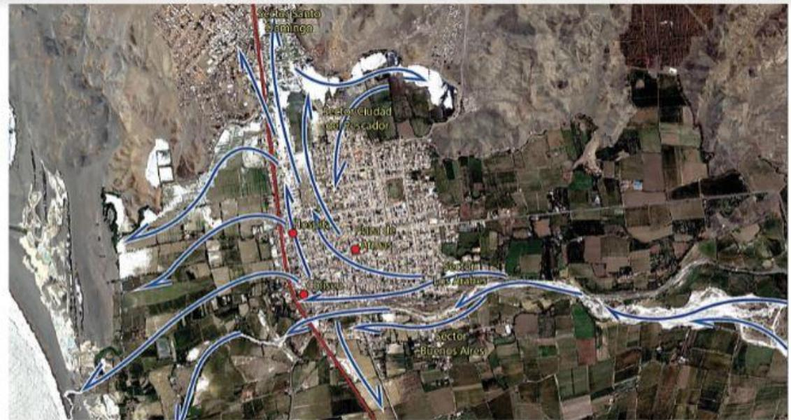
Ilustración 12 Imagen de la representación de la crecida del Río Huarney (flechas azúles) del 17 de marzo del 2017, línea roja Carretera Panamericana. Fuente: INGENMET, Análisis Geológico, Geomorfológico y Peligros de la cuenca media y baja del Río Huarney.
